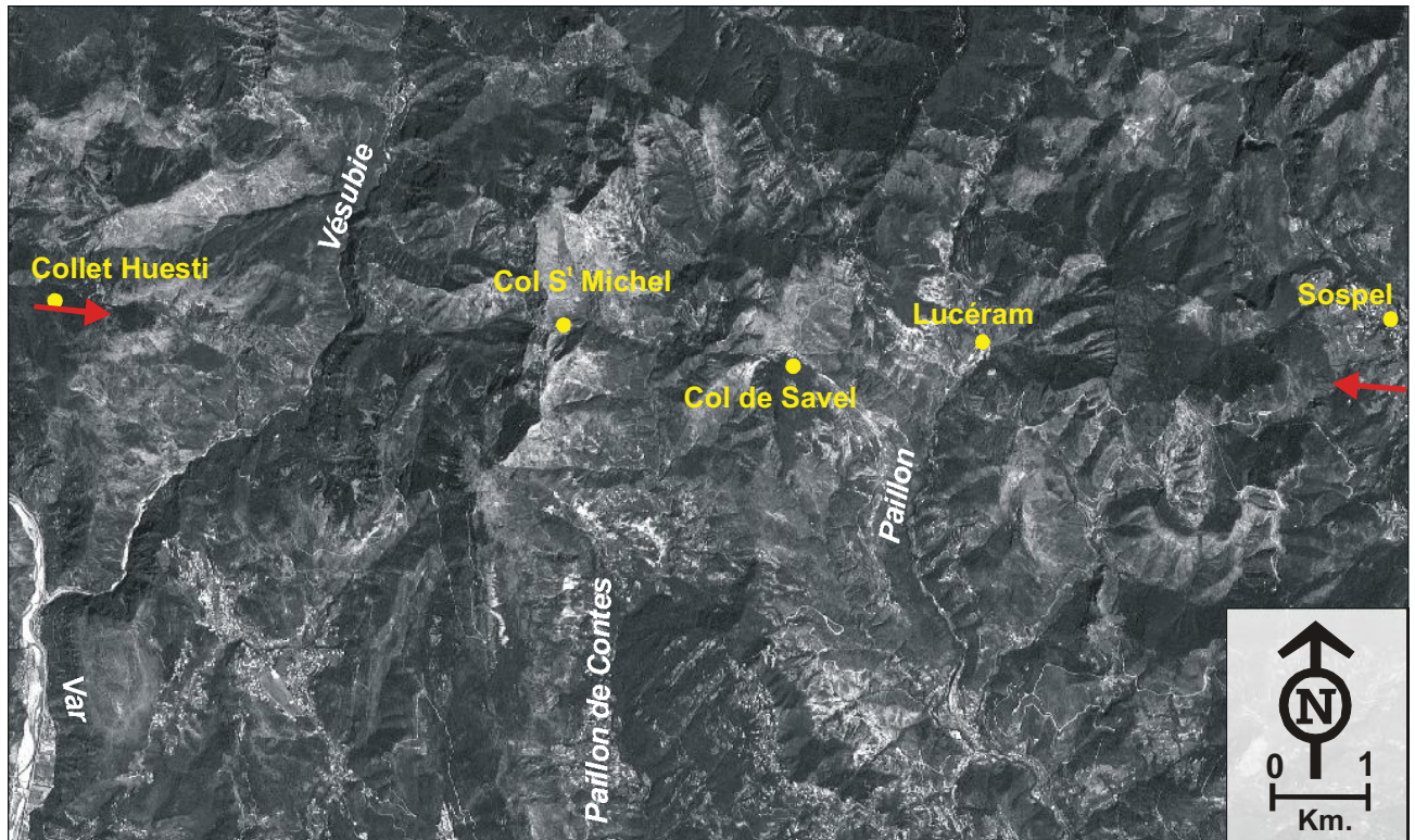
Figure 28. Partie occidentale de l'alignement N100°E Col Saint Michel – Sospel marquant fortement la morphologie sur image Spot.
