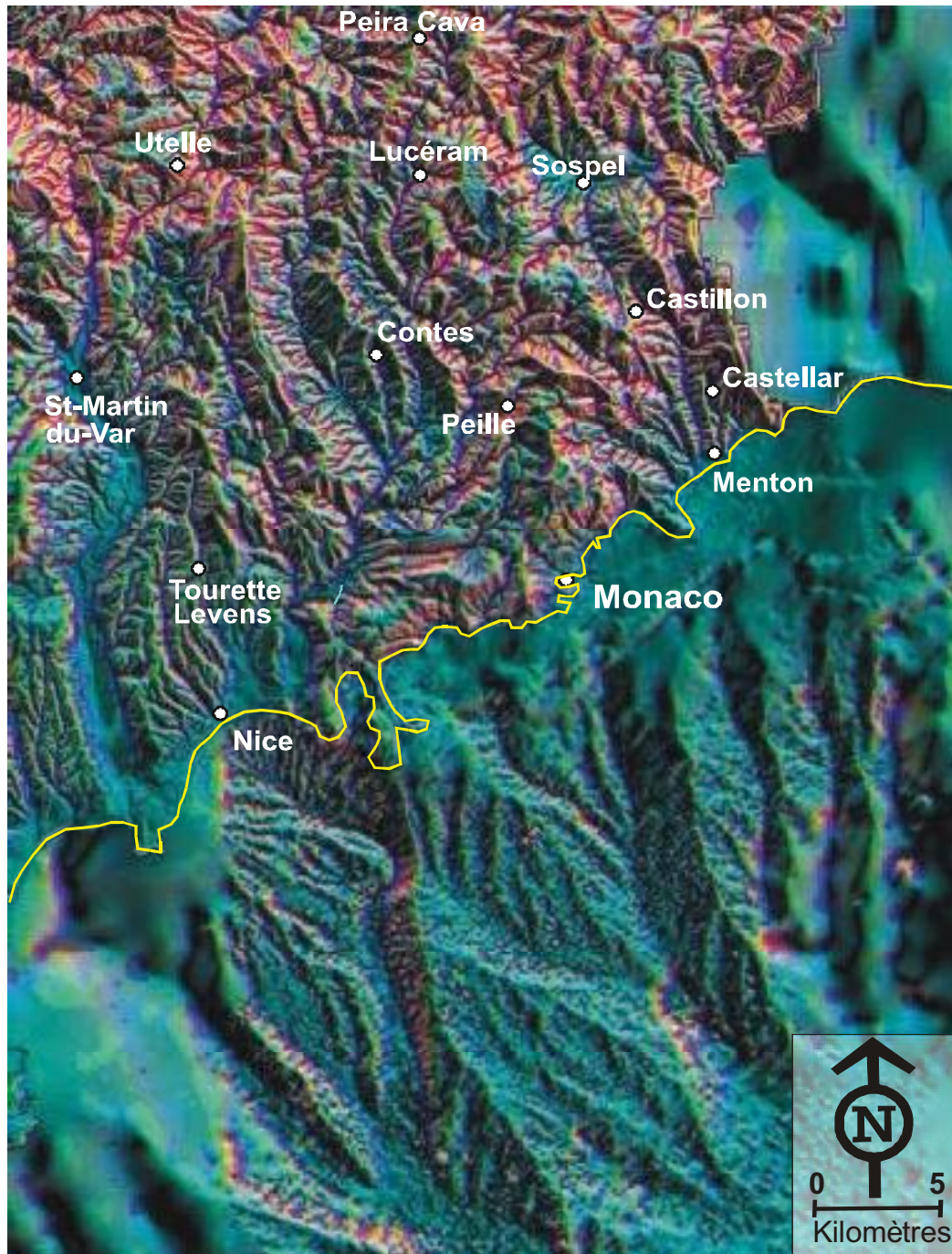
Figure 22 : MNT au 1/25.000 e terre et mer calculé respectivement à partir des données altimétriques de l'Institut Géographique National (IGN) issues de photogrammétrie au 1/60.000 e et d'une compilation des données bathymétriques de l'IFREMER, SHOM et LHF © Eosys – DEUC.
